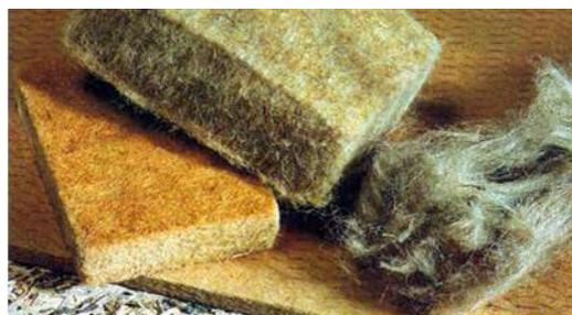
圖2-7.3 取代化學發泡材料的天然纖維隔熱材
